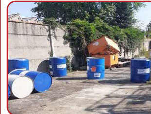
Stockages de produits chimiques sans rétention en limite de site
