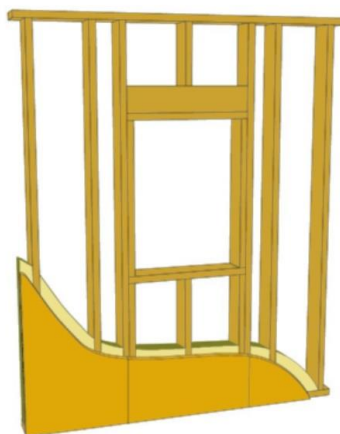
Principe de réalisation d'un chevêtre (Ossature Bois)
