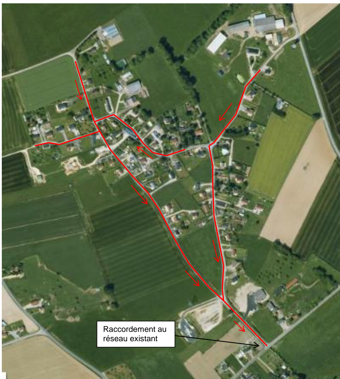
Figure 6 : Représentation graphique de la solution d'assainissement collectif étudiée pour le hameau Le Maupas
