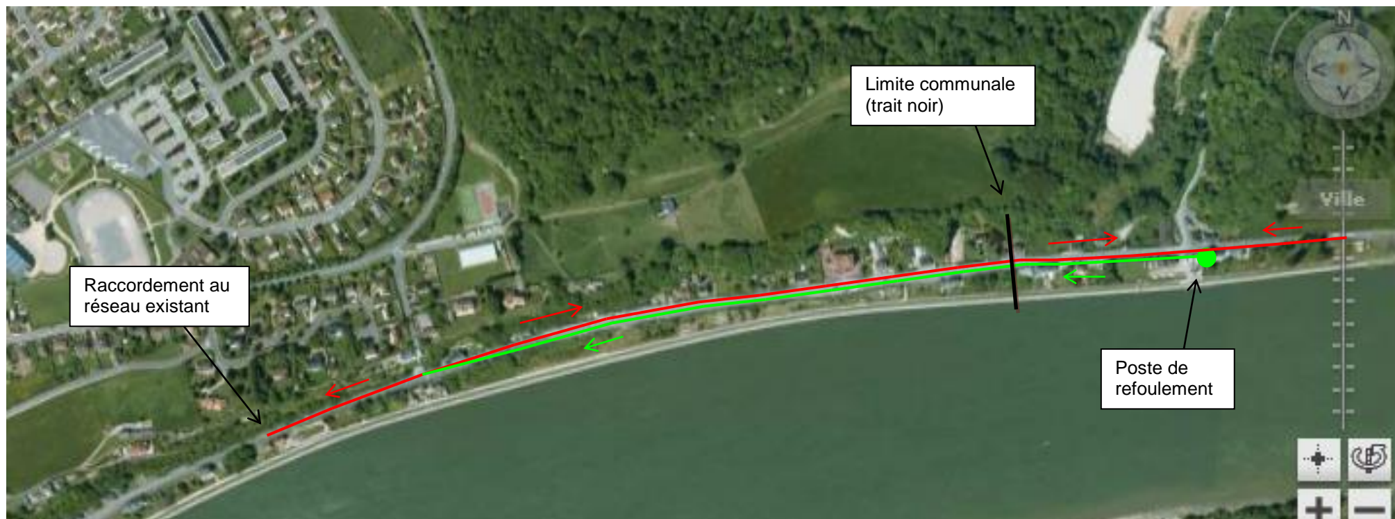
Figure 5 : Représentation graphique de la solution d'assainissement collectif étudiée pour le secteur RD982 (16 habitations de Duclair + 11 de Saint-Pierre-de-Varengeville)
