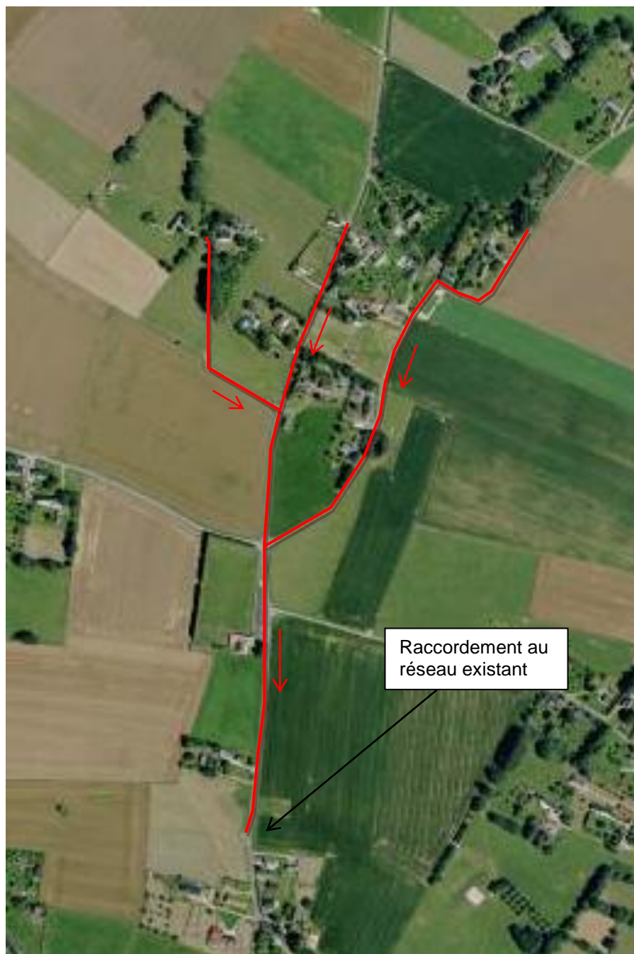
Figure 5 : Représentation de la solution d'assainissement collectif étudiée pour le secteur rue de Trubleville / RD63 (22 habitations au total)
