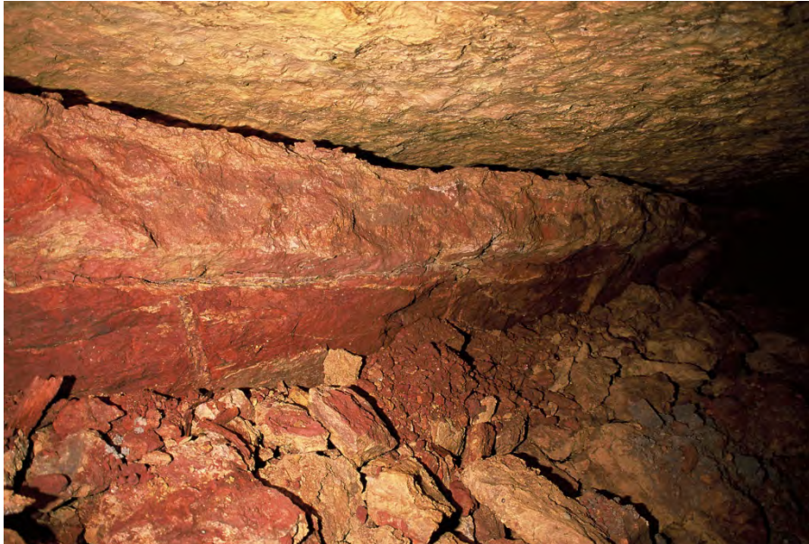
Figure 15 : Décollement du toit de la couche au contact du calcaire (May-sur-Orne). Photographie D. Butaeye
