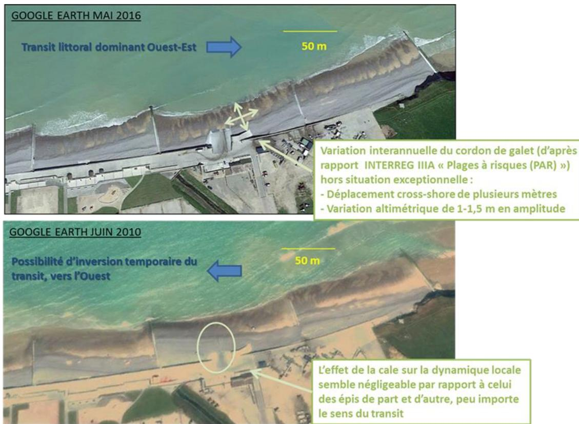
**Fig. 21. Schéma bilan – fonctionnement hydrosédimentaire local**
