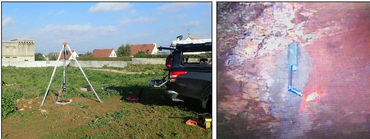
Figure 6 : Inspection vidéo-laser à partir de la surface.
