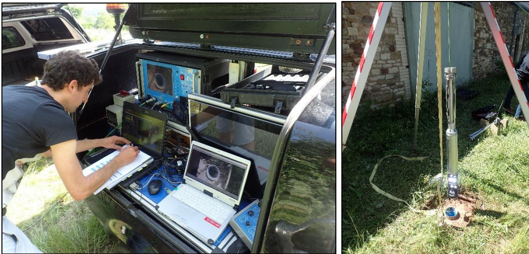
Illustration 6 : Inspection à partir de la surface avec la caméra vidéo-laser.
