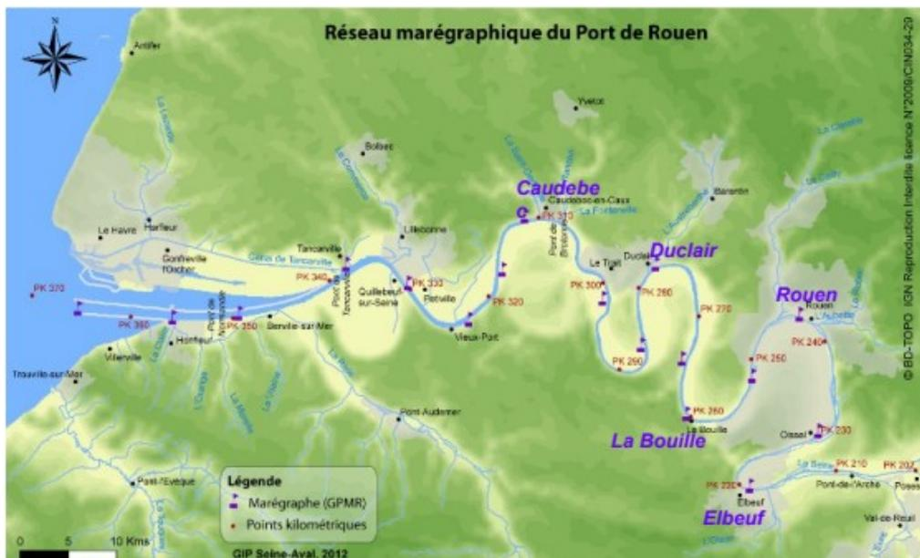
Figure 1: Instrumentation du tronçon Seine aval, marégraphes du GPMR, fond GIP SA 2012
