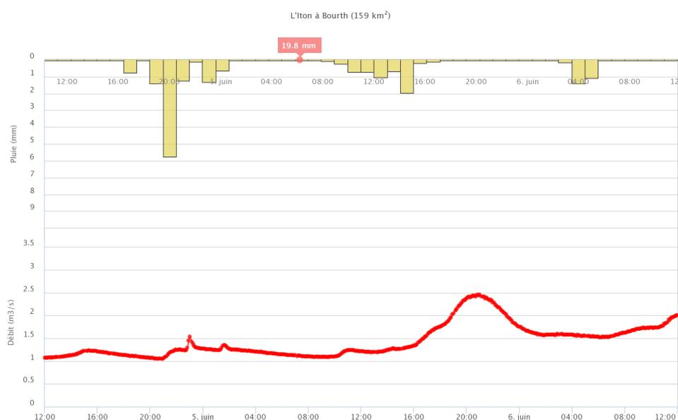
*Illustration 5 : réaction observée à la station de Bourth ( $Q_p = 2,46 \text{ m}^3/\text{s}$ , le 5/06 à 21h) et cumul pluviométrique associé*
