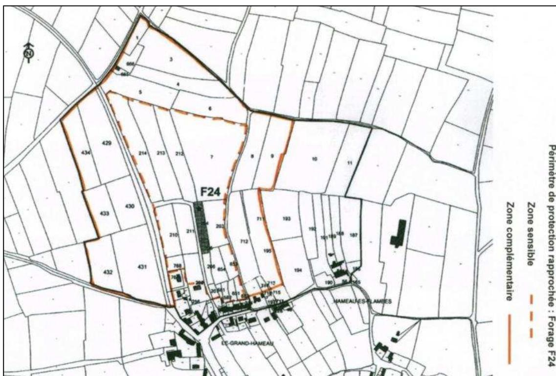
Figure 12 : Périmètre de protection de captage du forage F24
