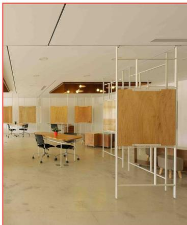
*Exemple de système pour reconfigurer un espace avec des panneaux mobiles tenus par un rail au plafond (source : Start-up Lab, Taiwan)*
