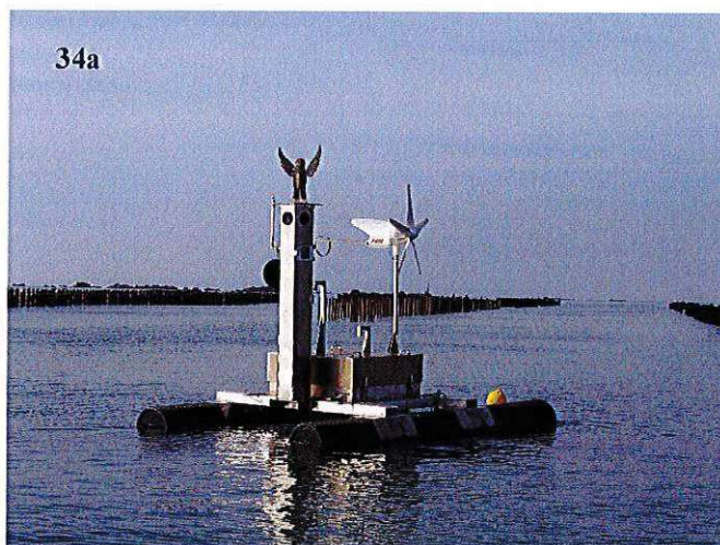
Figure 34 : Balise sonore testée à Chausey par le groupe de travail en 2007 (34a), peu résistante dans ce type de milieu (34b).
