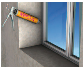
Amélioration de l'étanchéité
