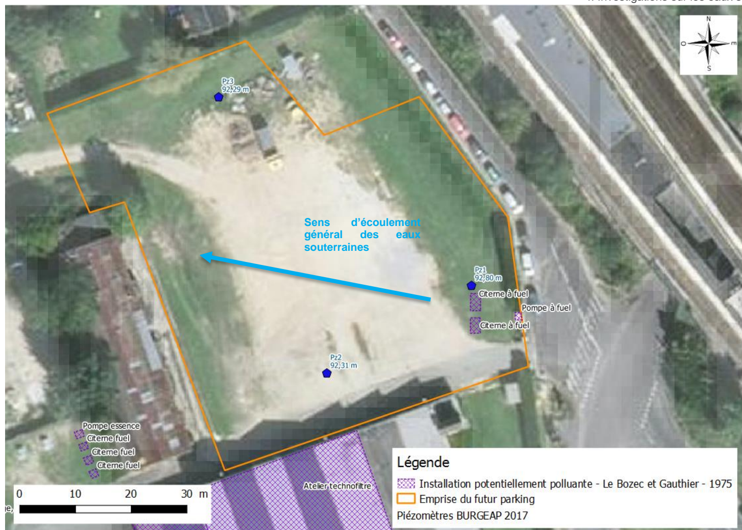
Figure 5 : Localisation des ouvrages et côte relative de la nappe (10/11/2017)
