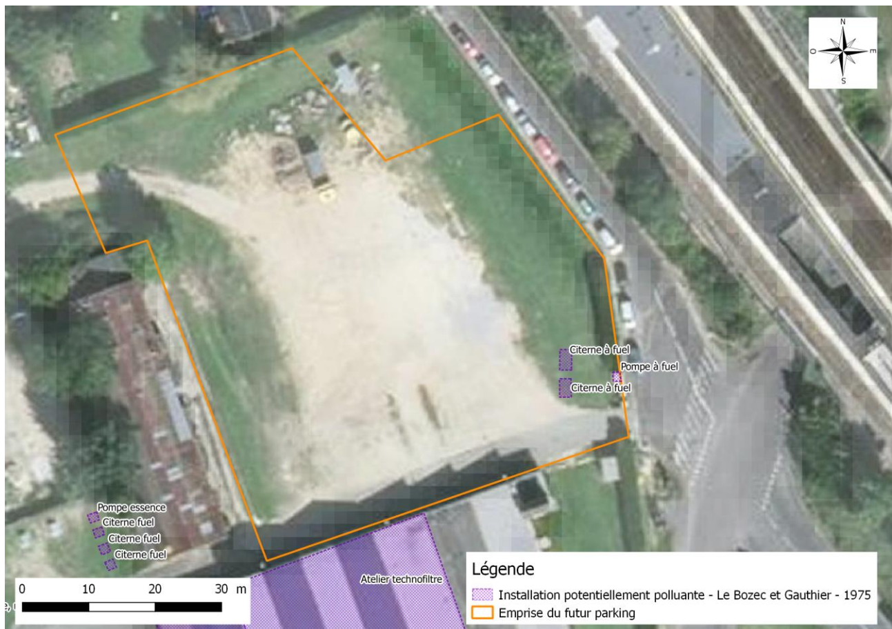
Figure 3 : Plan des installations présentes au droit et à proximité du site à l'étude
