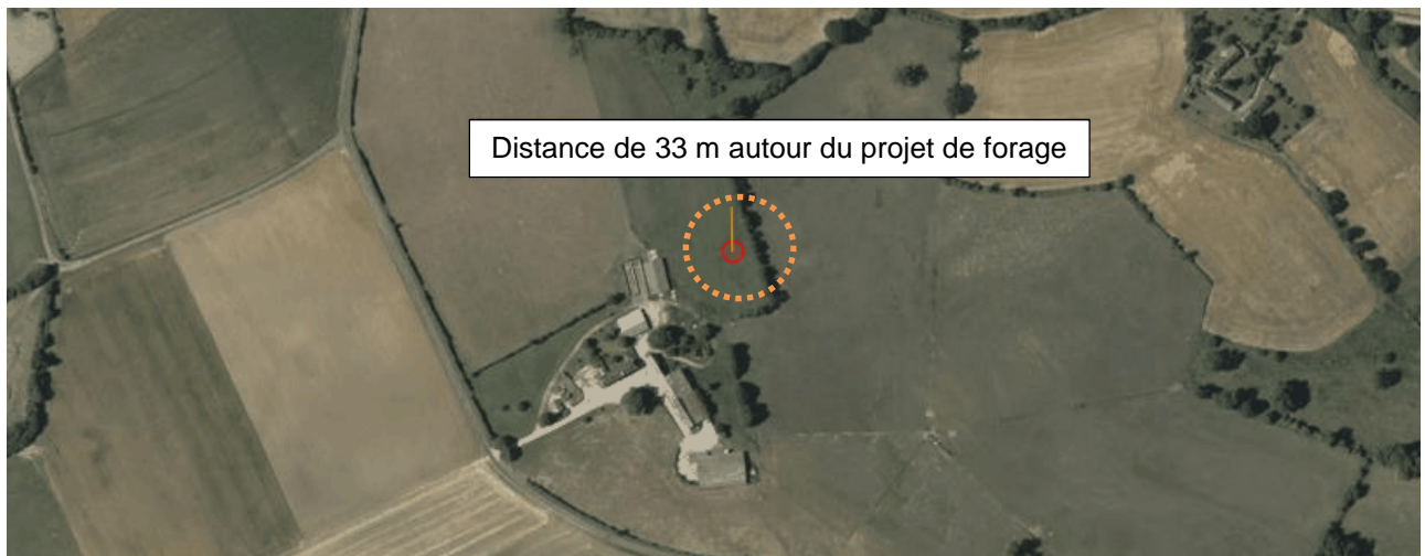
Zone d'alimentation en eau du forage pour une recharge faible (Source : Infoterre.brgm.fr, 2019)
