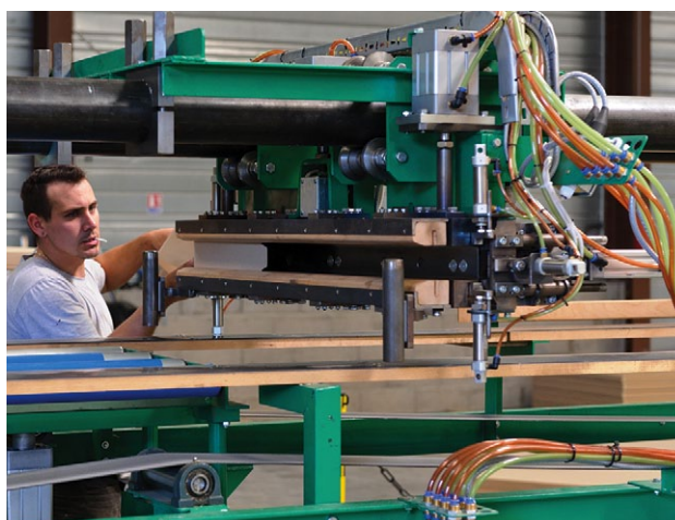
Collage de bandes cartonnées aux extrémités du panneau de paille ©Arnaud Bouissou/METL-MEDDE
