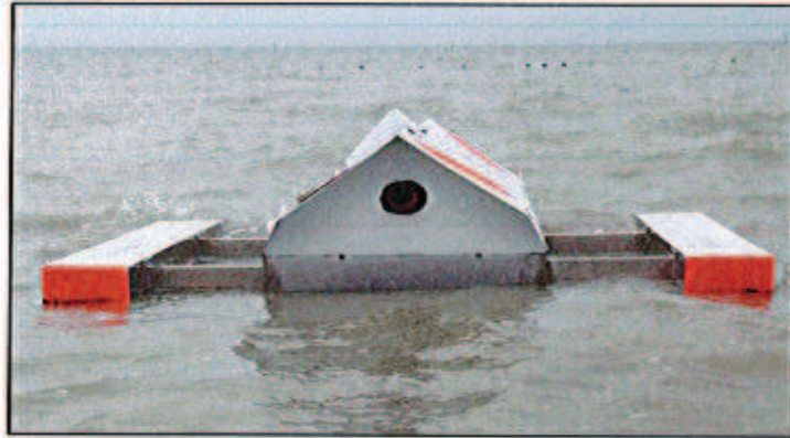
Figure 1 : Canon à propane ( Ifremer Saint-Malo, 2001, BELLANGER, 2002 )
