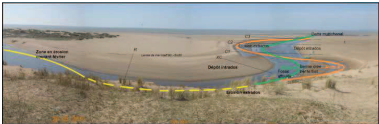
Figure 16 : résultats d'une expérimentation du S-ABLE dans le cadre d'une stabilisation de chenal estuarien (le Boivre, Saint-Brévin-les-Pins - source : CEREMA)
