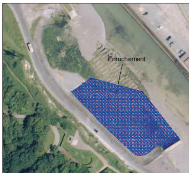
Figure 8 : Couverture de la partie Sud du brise-lames par un enrochement naturel
