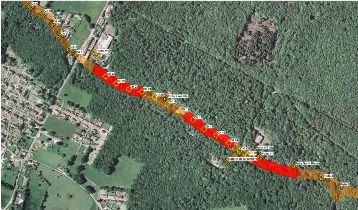
Figure 21 : localisation des secteurs du flanc sud cartographiés en aléa fort (rouge)
