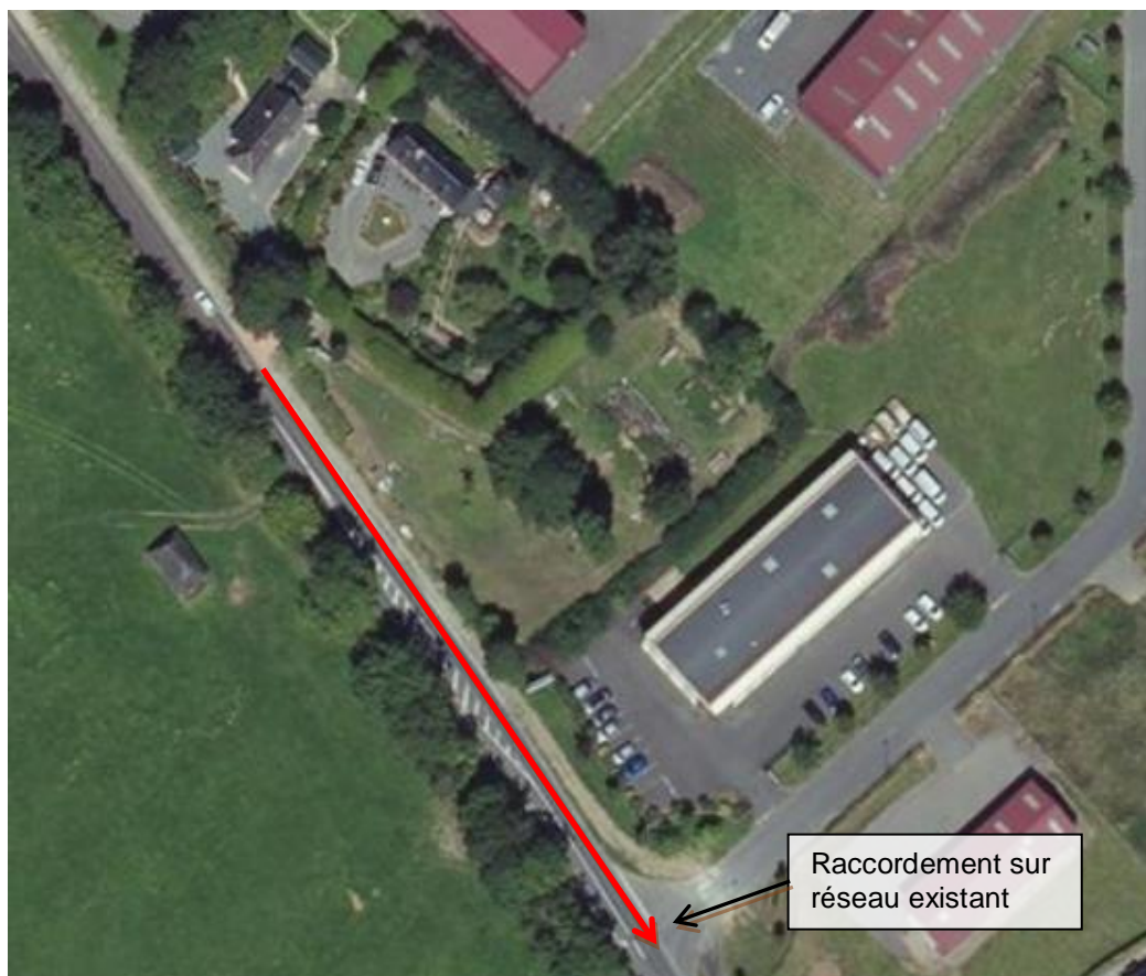
Figure 14 : Représentation de la solution d'assainissement collectif étudiée pour le secteur 4 – Route de Branville / RD45
