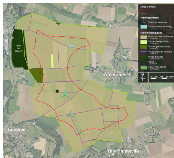
Illustration 2: plan présentant la zone d'implantation potentielle (ZIP), qui constitue « l'aire d'étude immédiate » de l'étude d'impact – source : étude d'impact du porteur de projet. Ce plan permet de localiser les trois éoliennes du parc éolien de Gueures déjà en exploitation.
