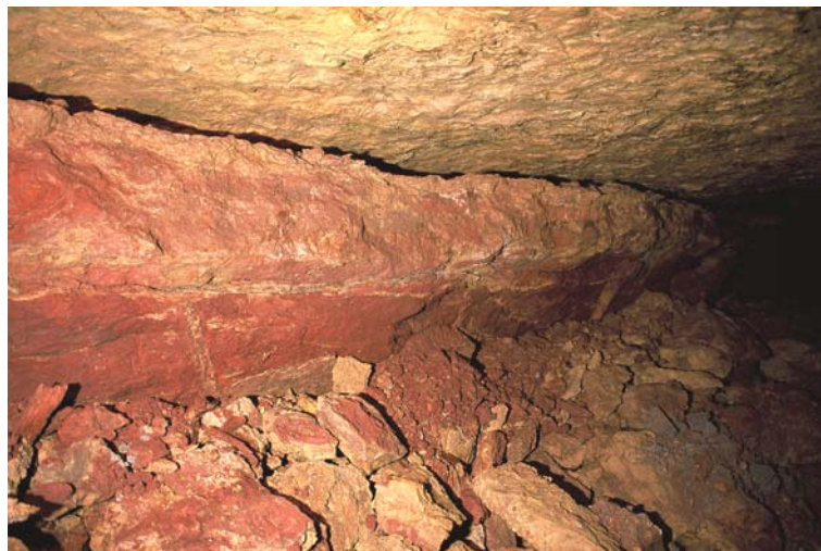
Photographie 7 : décollement du toit de la couche au contact du calcaire (May-sur-Orne). Photographie D. Butaeye
