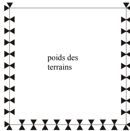
Figure 13 : Conditions aux limites du modèle pour les coupes transversales
