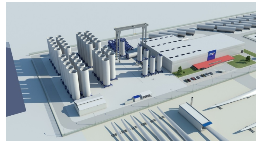
Illustration de l'usine de mâts
