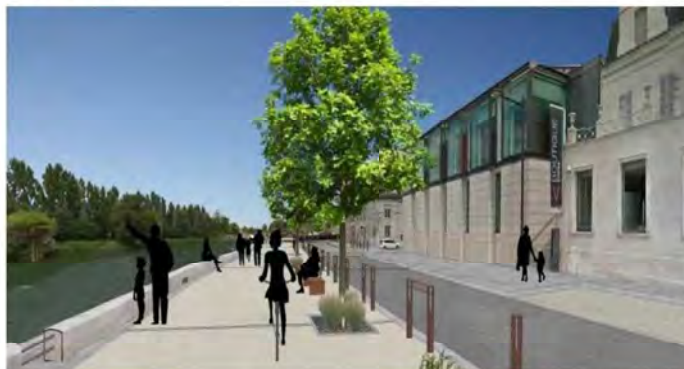
Cognac, Projet de réaménagement des quais (Impact Urbanisme) La voie a été réduite pour agrandir le trottoir, les stationnements sont limités. Un muret protège du vide tout en dégagant la vue sur la rivière.
