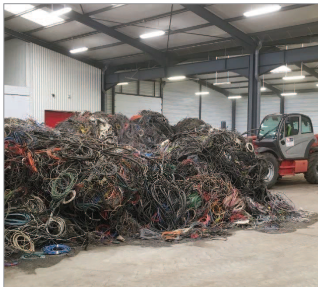
Figure 4 : Aire de réception-tri des déchets de câbles
