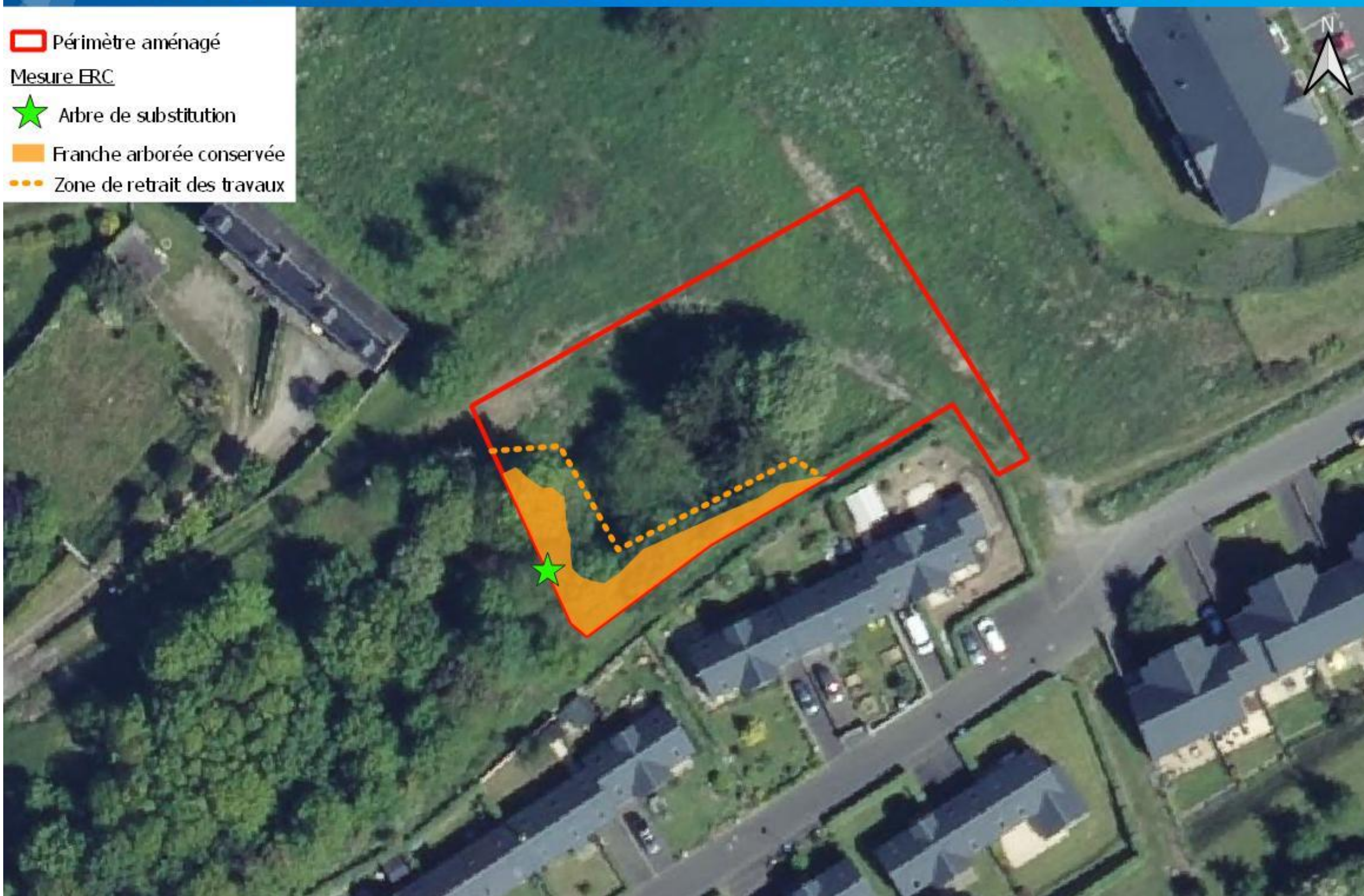
Figure 7 : Zoom sur les aménagements réalisés au droit du périmètre dédié aux mesures compensatoires
