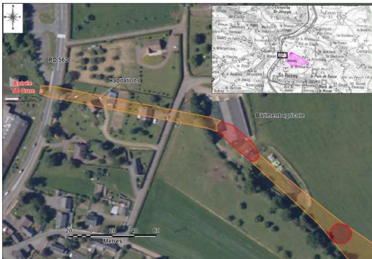
Figure 1 : Extrait de la carte d'aléas sur la commune de Saint-Rémy-sur-Orne (14) au niveau du travers-banc de l'Orne (cf. [2]) - Fonds SCAN 100® et BD ORTHO® IGN (PVA 2 de 2009) (en rose : emprise des travaux miniers ; en orange : aléa effondrement localisé de niveau moyen ; en rouge : aléa effondrement localisé de niveau fort)
