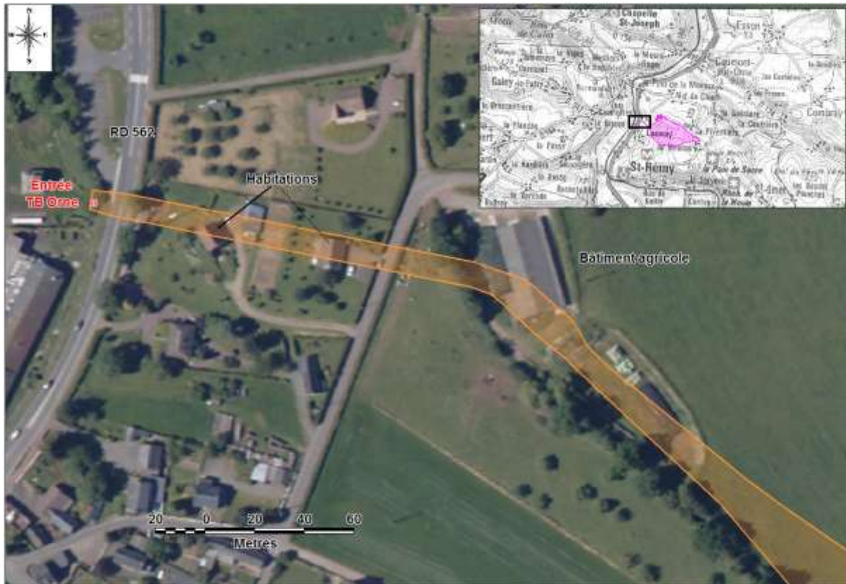
Figure 5 : Extrait de la carte d'aléas mise à jour sur la commune de Saint-Rémy-sur-Orne (14) au niveau du travers-banc de l'Orne (cf. [2] - Fonds SCAN100® et BD ORTHO® IGN (PVA 4 de 2009) (en rose : emprise des travaux miniers ; en orange : aléa effondrement localisé de niveau moyen)
