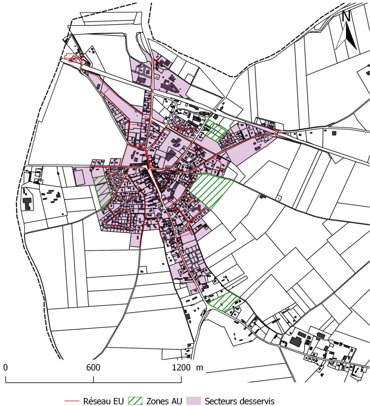
Figure 20 – Délimitation des secteurs desservis par le réseau collectif des eaux usées
