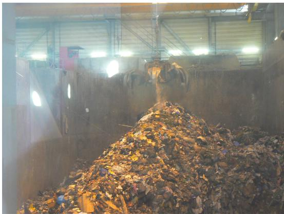
La capacité totale de la fosse permet de recevoir 7000 tonnes de déchets. Le stockage des déchets doit également permettre de maintenir l'usine en fonctionnement 24 heures sur 24 et 7 jours sur 7.
