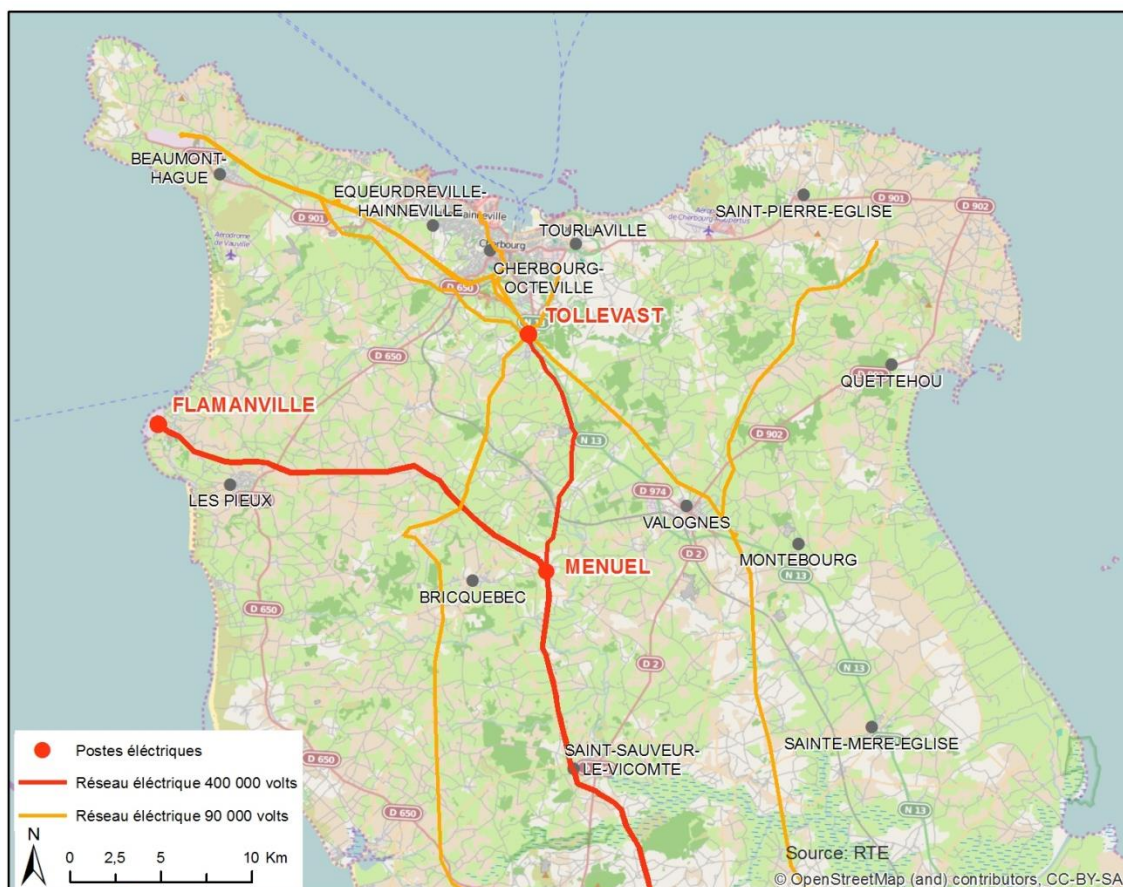
Figure 46 : Localisation des postes 400 000 volts du nord Cotentin
