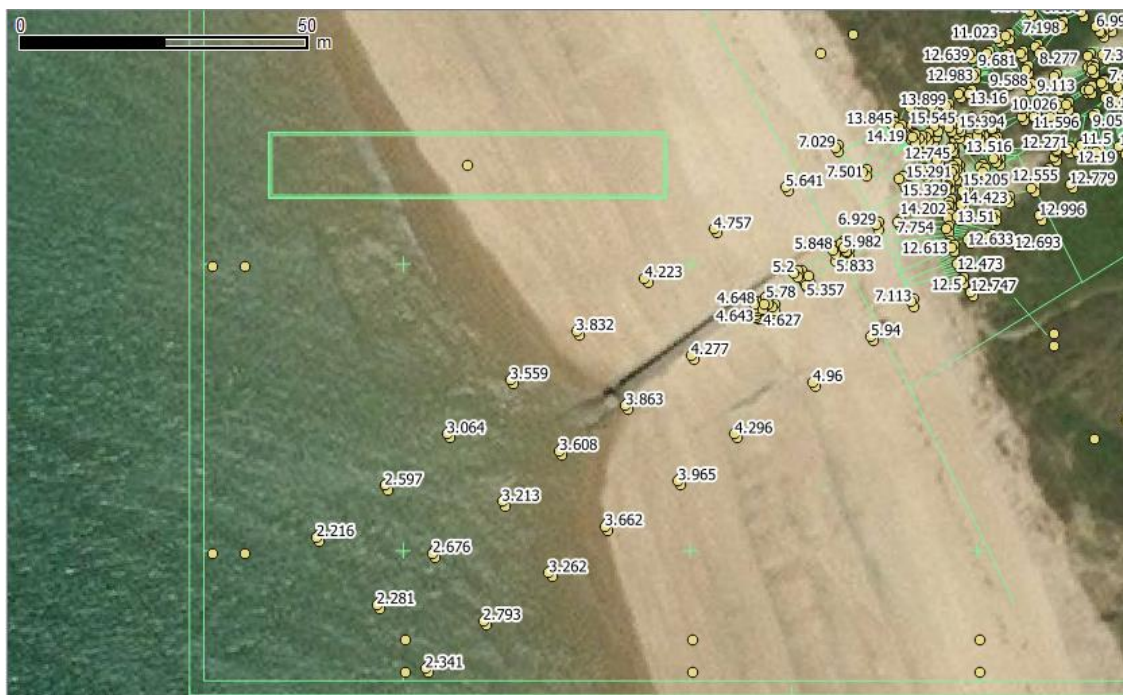
Figure 3 : Vue en plan relevé géomètre
