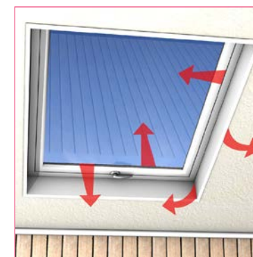
Sources d'infiltration d'air
