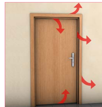
Sources d'infiltration d'air
