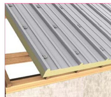
Après : renforcement des fixations
