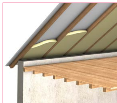
Isolation thermique par l'intérieur sous rampant
