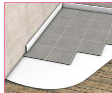
Pose d'un revêtement de sol dur
