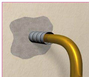
Colmatage direct avec garniture de protection
