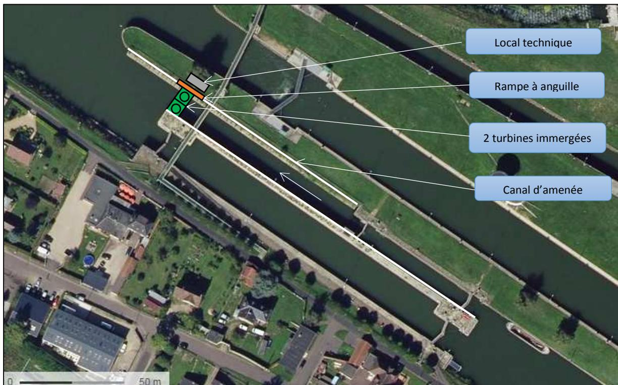
Positionnement des ouvrages de la centrale hydroélectrique de Port-Mort
